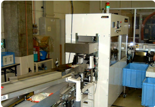
連続抜き取り検査の為の密封度監視装置
