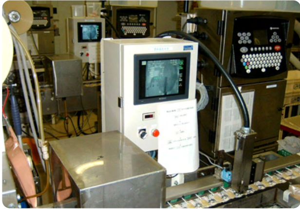
連続個別検査の為の赤外線監視装置
